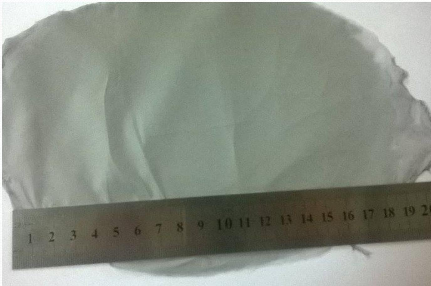
Figura 4- Fotografia do filme de Ecoflex® e grafite, produzido por eletrofição com vazão  $1,0 \text{ mL h}^{-1}$ , tensão de 14 kV e distância de 15 cm.
